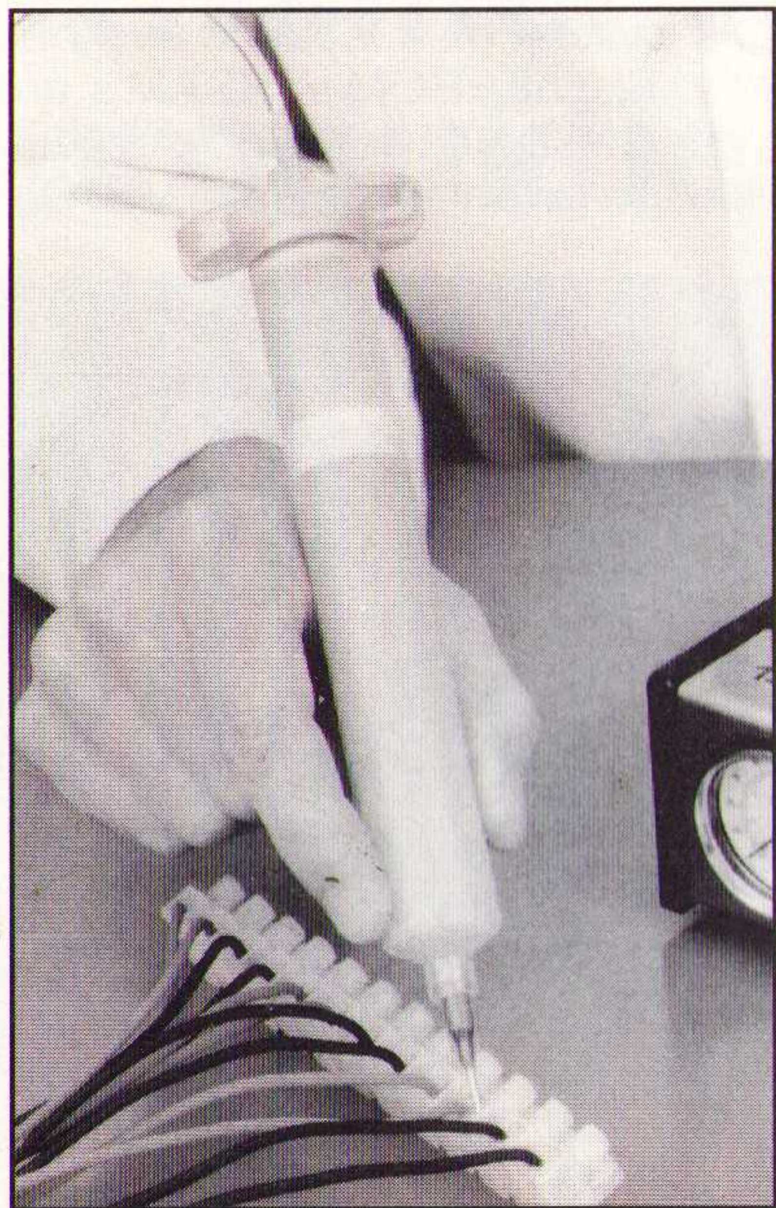
Doseerspuit voor elektro-pneumatische doseerapparaten.
